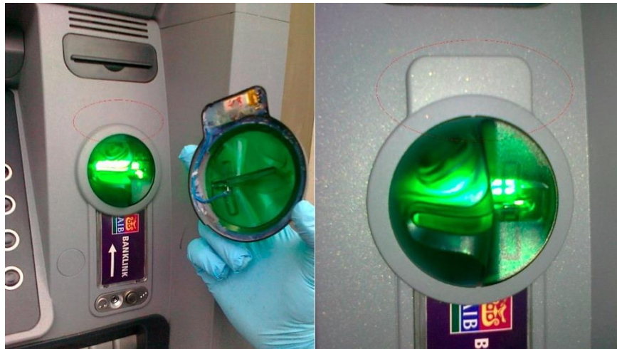
57. ábra: Kártyamásoló eszköz ATM-en
